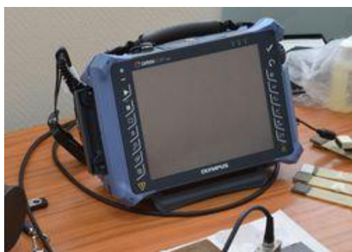
Ультразвуковой дефектоскоп для проведения неразрушающего контроля композиционных материалов OLYMPUS OmniScan MX2
