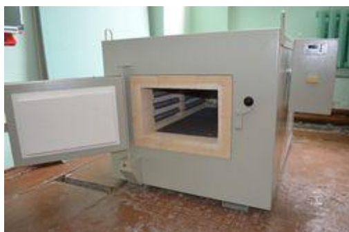
Электродпечь для лабораторий прочности и надежности конструкций летательных аппаратов
