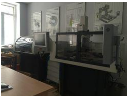
Интерактивный учебный класс с учебным токарным станком CC-D6000 E и фрезерным станком CC-F1210 E с ЧПУ "CNC Омега"
