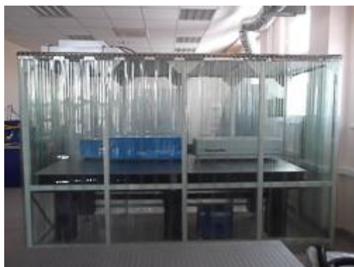
Система очистки зоны эксперимента ЧИСТАЯ ЗОНА с фильтровентиляционным модулем PAFG-FFUST-AL-800
