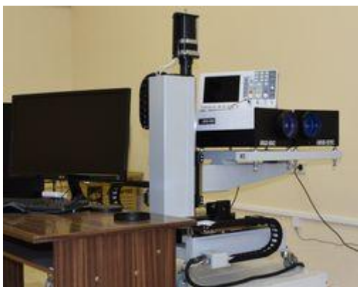
Трёхкомпонентный полупроводниковый лазерный доплеровский анемометр с возможностью измерения размеров частиц для диагностики газожидкостных потоков (ЛАД-078С)
