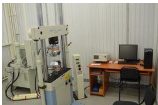
Серво-гидравлическая испытательная машина SHIMADZU EHF-E с удлинением колонн на 400 ммв
