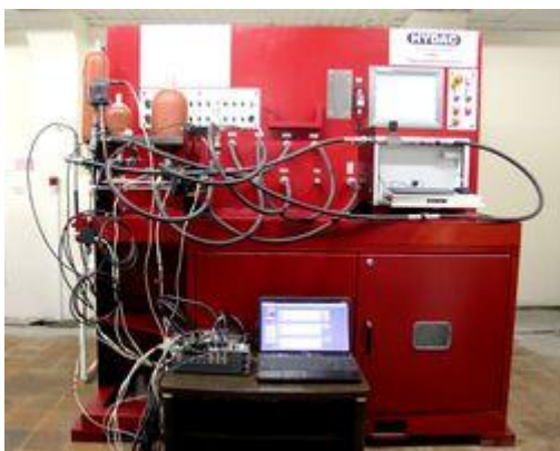
Стенд «Диагностика и идентификация гидросистем с комплектом оборудования» НР-R00381-01-11-0-00-000-0.0
