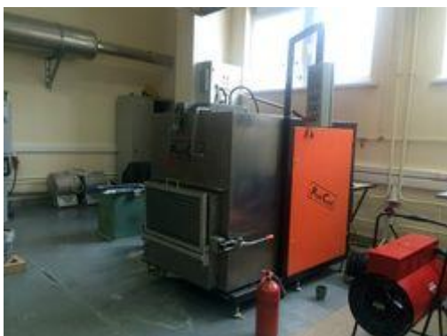
Система для вакуумного литья нержавеющей и конструкционных сталей SGa 3500
