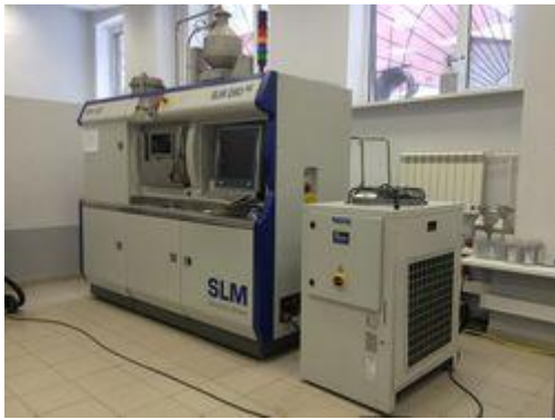
Установка селективного лазерного сплавления металлического порошка SLM 280HL с лазером 400 Вт в базовой комплектации
