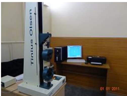
Универсальная испытательная машина H5KT-0536 с серво - электромеханическим приводом
