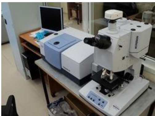
ИК Фурье-спектрометр Bruker Tensor 27 совмещенный с ИК микроскопом Hyperion 1000
